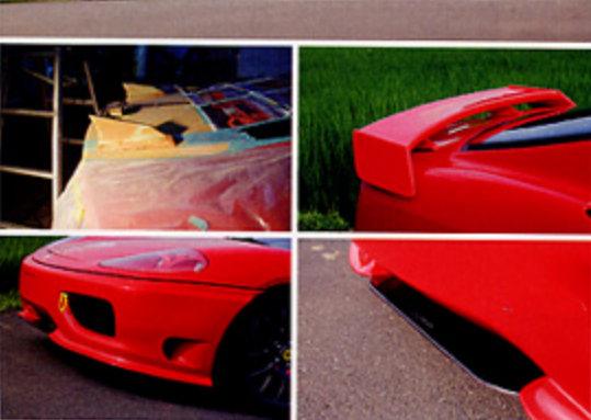
ついに完成した360モテナ用のフロントスポイラーとリアウイング。代表の森田産産（写真右）乗っているフェアースポーツの制作現場と、太田の開発経験が現車輸出したカタチだ。リアウイングは写真のようにまず左側で形を造り、機密漏れで得意も逃げたそう。特に得意を空気の流れる方向に左右に上げるように造り出した。翼板の形状も、リアワードとフィットするよう、やはりデザインが決められた。フロントスポイラーはセンター駆動がカーボン製で造り出し、そこにTEZZOのロゴが入っている。左右のアンダーリップはご覧のように少し前方に出ておりダウンフォース向上に貢献するはずで、今からサーキットテストが楽しみだ。
