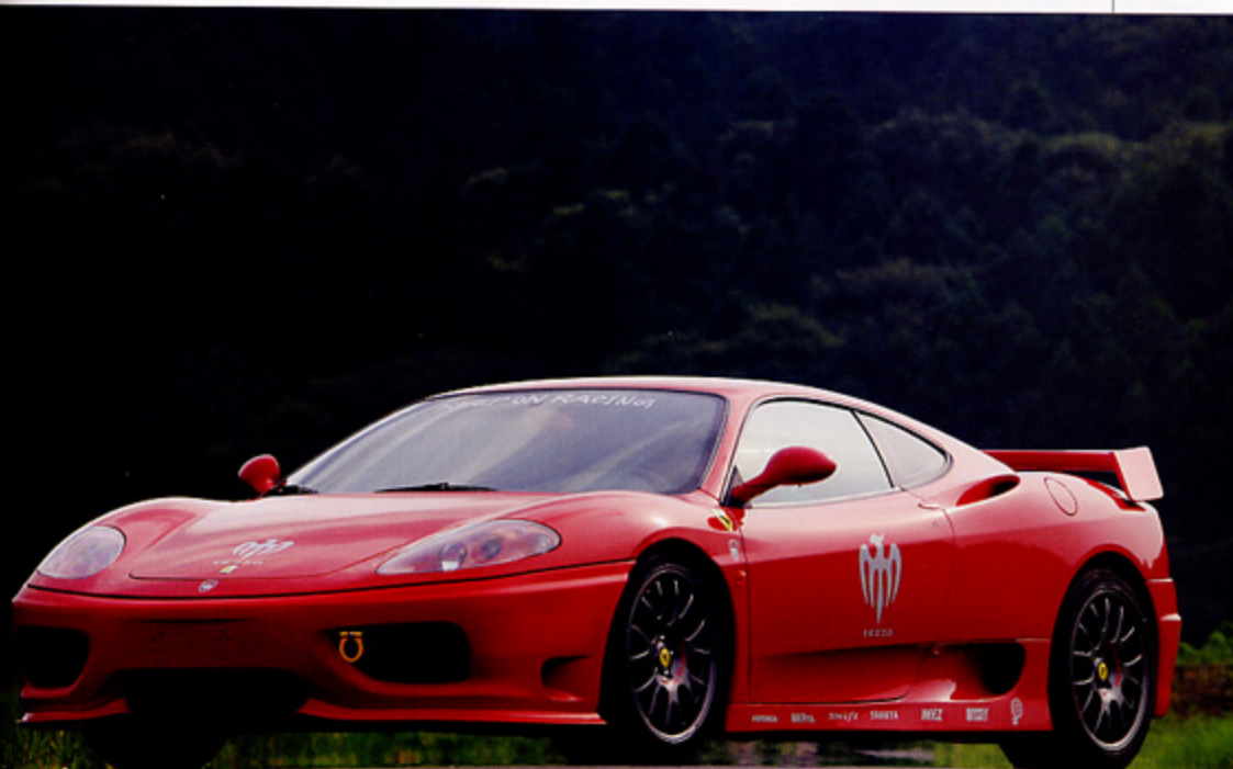
影があるウイングが装着された。太田「森田が、モテナをカッコよくないかと思っていた点は、ウイングがついていないことだ。ランズのダウンフォースが不足したランズの取れないカタチに足らなからだった。今回、ウイングを付けたことで前後のダウンフォースのバランスがとれてグッドとスタイルが引き締まって見えるようになった」。森田にとっては、太田の合格点が出たことはいえ、試作をつけた段階では、また仕事は半分も終わっていないという気持ちだった。一体自分が造ったエアロが実際にサーキットで効果を発揮するのか。
