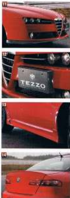
11 フロントスポイラーは、高速安定性に寄与。12 ナンバープレートの台座もカーボン製。13 サイドステップには、ブレーキ冷却用のダクトが備わる。14 カーボン製のトランクリッドは、スポイラー一体型。軽量化に大きく貢献する。
