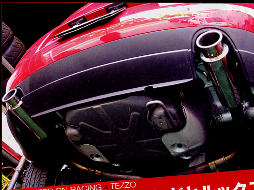
右がノーマルのサイレンサー、左がTEZZOの砲弾型サイレンサー。その大きさの違いは一目瞭然だ。性能や音質だけでなく、軽量化も実現した。
