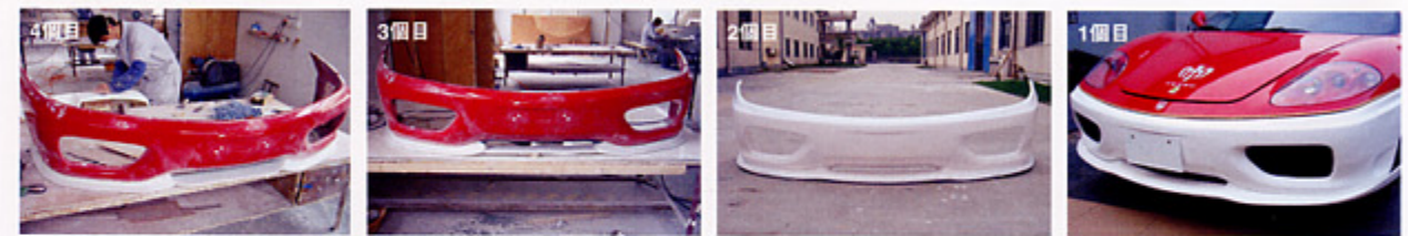
フロントリップスポイラーは、試作1個目から4個目まで森田が納められて改良を重ねられた。森田の経験から太田の経験から得たエアロダイナミクスの理解が活かし、製造が進んでいく。その後、森田をはじめとしたスタッフが何度も造り直し、決して自分に妥協しないのは、物造りの真諦だ。
