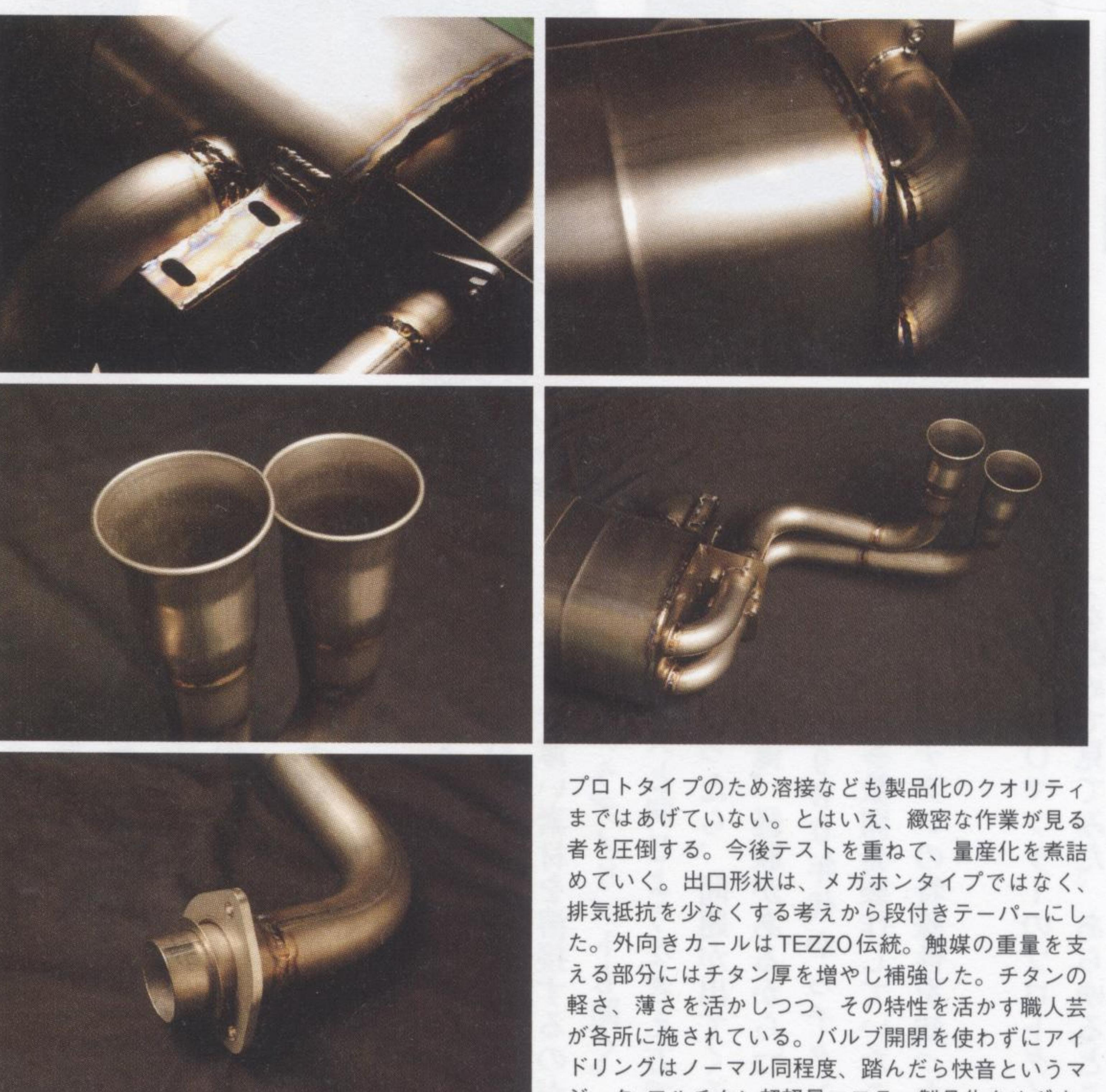
プロトタイプのため溶接なども製品化のクオリティまではあげていない。とはいっても、緻密な作業が見える者を圧倒する。今後テストを重ねて、量産化を煮詰めていく。出口形状は、メガホンタイプではなく、排気抵抗を少なくする考えから段付きテーパーにした。外向きカールはTEZZO伝統。触媒の重量を支える部分にはチタン厚を増やし補強した。チタンの軽さ、薄さを活かしつつ、その特性を活かす職人芸が各所に施されている。バルブ開閉を使わずにアイドリングはノーマル同程度、踏んだら快音というマジック。フルチタン超軽量マフラー製品化をめざす。
